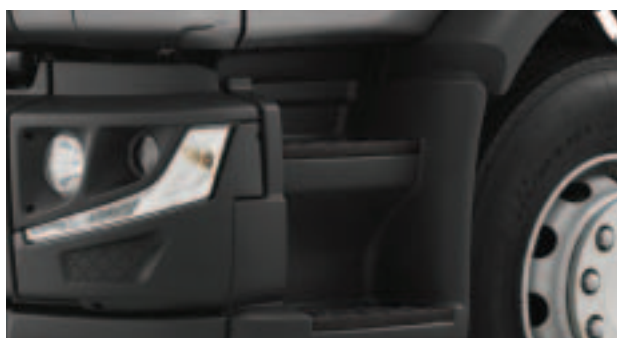
GRADINI TIPO SCALA con un rientro di 80 mm tra i gradini per agevolare l'accesso alla cabina.
