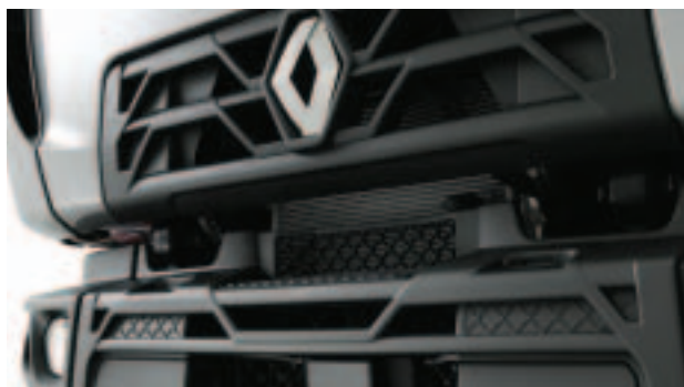
GRADINI D'ACCESSO AL PARABREZZA antiscivolo, per facilitare la manutenzione del veicolo.
