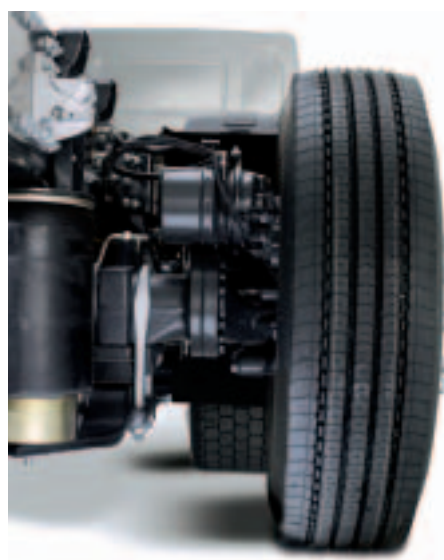
SOSPENSIONI POSTERIORI PNEUMATICHE offrono maggiore stabilità e protezione delle merci.
